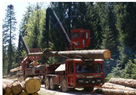
Entrindungsmaschine mit eBSS Debarking machine with eBSS
